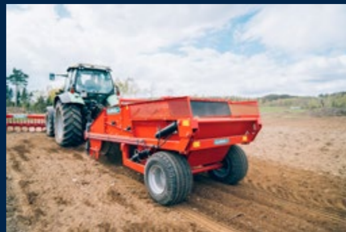
Hydraulisk løft av hjulgang gir en tipp høyde på opptil 2,5 m.
