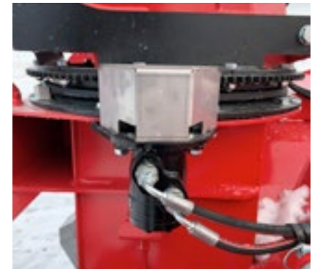
Ny større 50cc hydraulikkmotor for sving av tut
