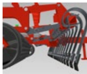
Parallellføring på sloddeplank gir samme angrepsvinkel på tindene uavhengig av arbeidsdybde
