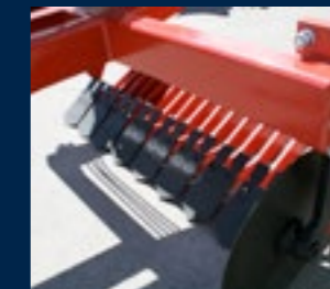
Belte kan leveres med med forskjellige lysåpninger. Fra 16 mm og til 44 mm.
