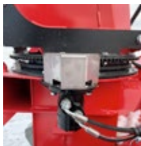
Ny større 50cc hydraulikkmotor for sving av tut.
