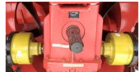
Stor solid girboks og clutcher for innmeterskruer.
