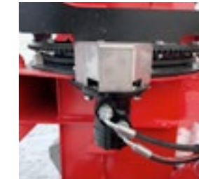
Ny større 50cc hydraulikkmotor for sving av tut
