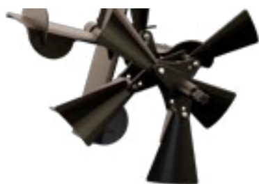
Justerbare innmatervinger for å minimere avstand mellom veien og vingene.
