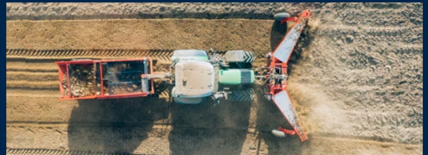
Belte kan leveres med med forskjellige lysåpninger. Fra 16 mm og til 44 mm.
