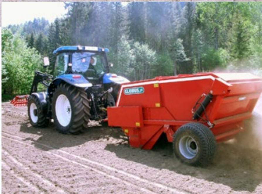
Hydraulisk løft av hjulaksling gir en tippøydde på 2 m.
