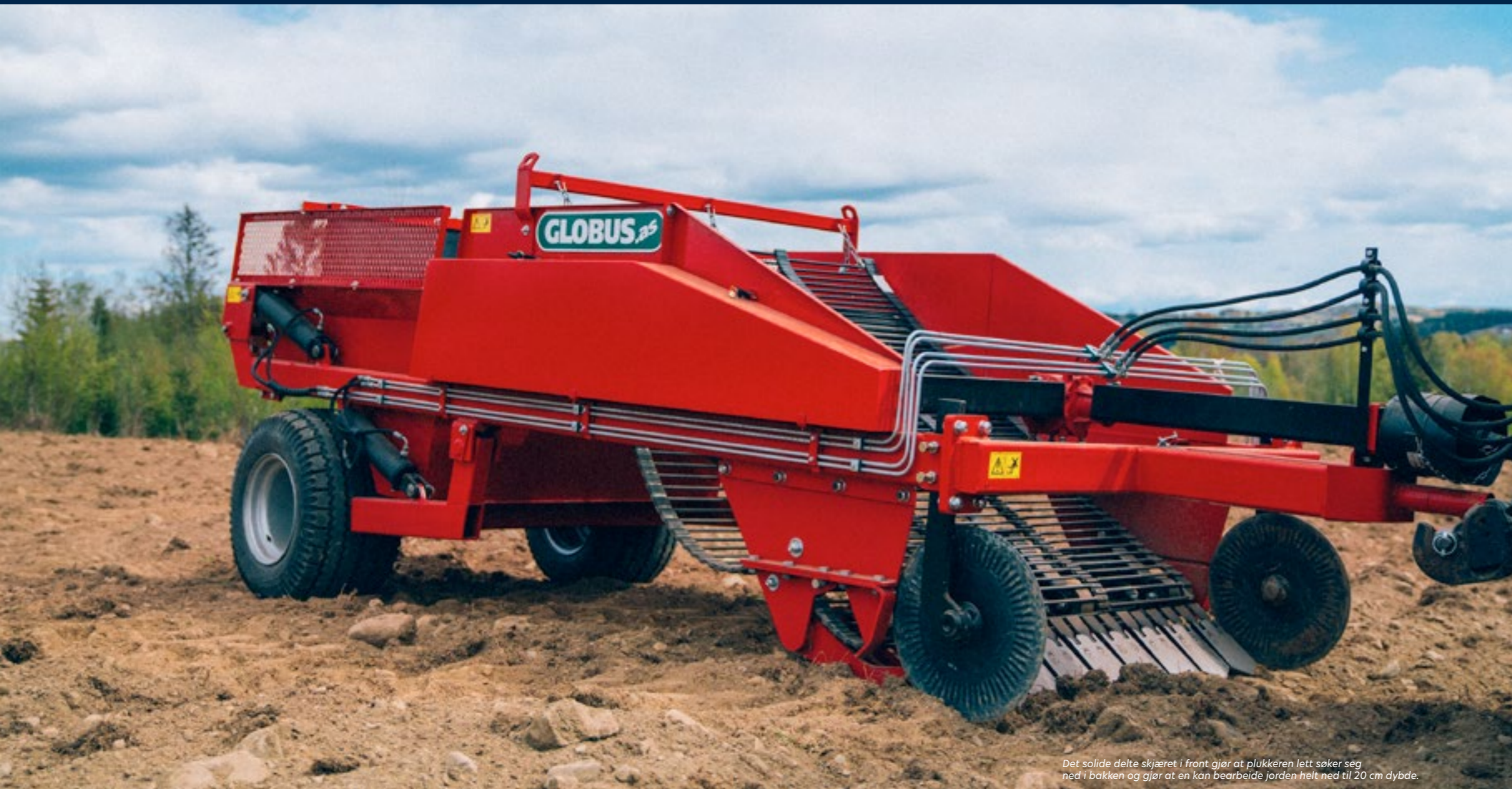
Belte kan leveres med med forskjellige lysåpninger. Fra 16 mm og til 44 mm.
