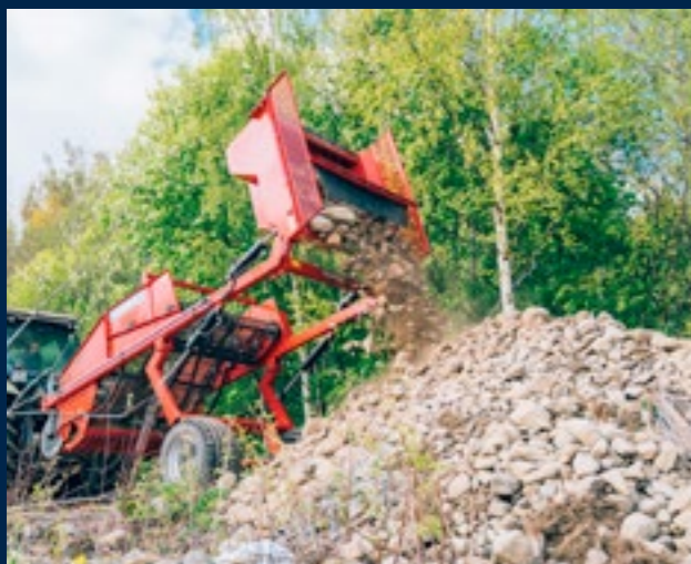
Hydraulisk løft av hjulgang gir en tipp høyde på opptil 2,5 m.
